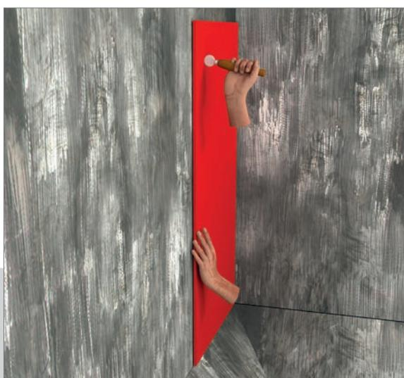
**6.** Danach mit einem Rändelroller über die Oberfläche gehen.
